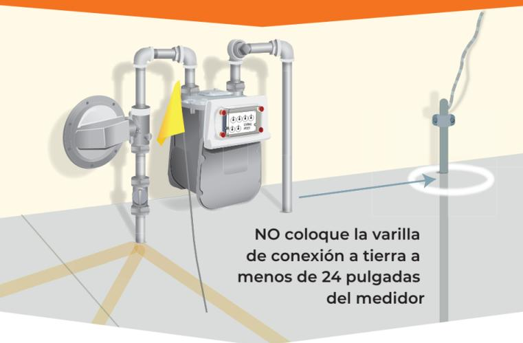
**NO coloque la varilla de conexión a tierra a menos de 24 pulgadas del medidor**
