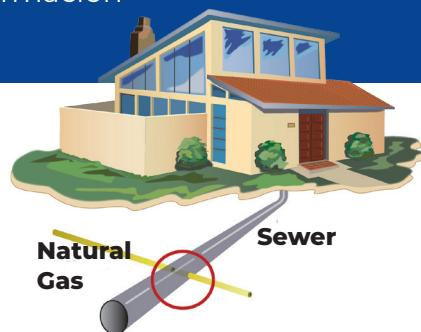
Hay una remota probabilidad de que una tubería de gas natural haya penetrado la tubería del alcantarillado cuando fue instalada usando métodos de construcción sin zanja. Si esto ocurrió, un equipo mecánico destapacaños podría dañar la tubería de gas natural cuando se esté despejando la tubería del alcantarillado, lo que puede resultar en una fuga de gas natural.
